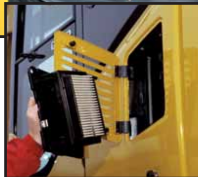
Filtre à air extérieur
