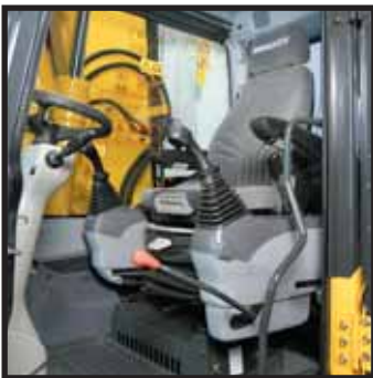
Plage de glissement du siège: 340 mm
